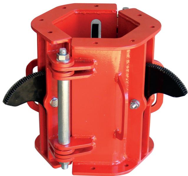
Il "COCCODRILLO" è un dispositivo di blocco automatico che permette di operare in sicurezza impedendo la caduta di batterie di perforazione e tubazioni o altre attrezzature durante tutti i lavori di perforazione o di manutenzione di pozzi.
